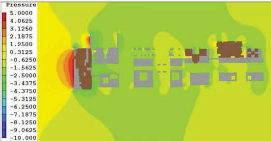
图A6-12 冬季1.5m高处压力分布图
