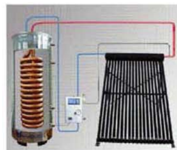
图F3-10 太阳能热水系统示意
