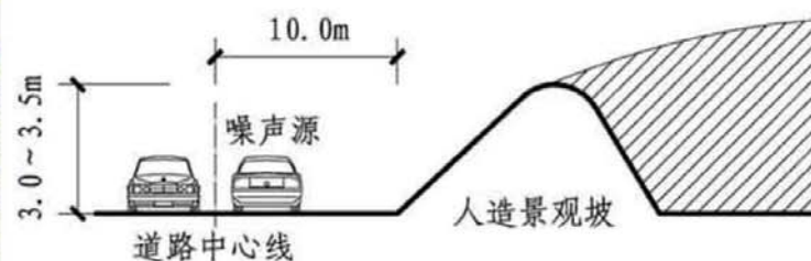
图A5-7 景观坡隔声作用示意图
