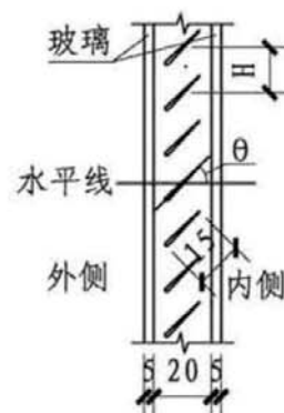
图E8-2 中空玻璃夹层智能内遮阳剖面示意图
