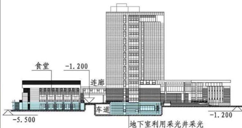
图F2-2 利用地形高差和采光井将自然光引入地下室示意图
