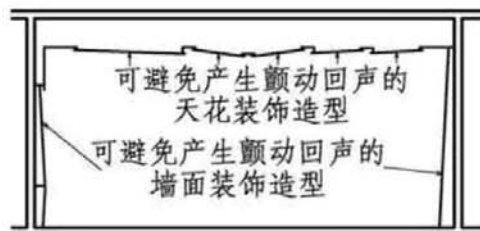
避免产生颤动回声的墙面与天花装饰造型
