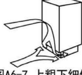
图A6-7 上粗下细体型 上部风对下部有影响
