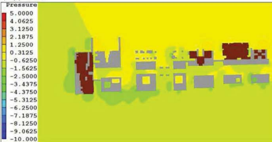
图A6-14 夏季1.5m高处压力分布图
