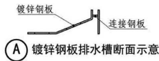
1 隐藏式雨水边沟做法示意
