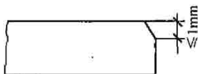
图 4 机械剪切面的边缘缺棱示意图
