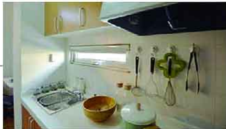
家务性厨房: 按照人体操作动线合理布置灶台、洗涤池、冰箱等位置; 厨房采用标准化尺寸, 并配置整体橱柜, 易于工业化施工建造。
