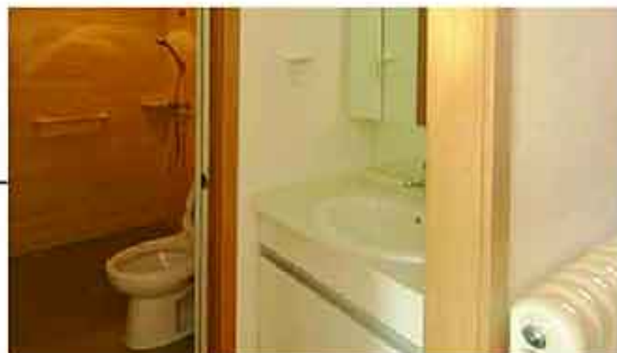
分离性卫浴(干湿分离): 采用干湿分离方式, 独立盥洗、如厕、洗浴空间, 提高使用效率; 卫生间采用标准化尺寸, 易于工业化施工建造。
