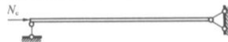
图 5.2.7 连墙件计算简图
